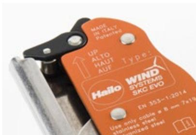
Das Auffanggerät HWS SKC EVO ist für das Steigschutz HWS-FAS 8 nach EN 353-1:2014 konzipiert und als zuverlässige Absturzsicherung an ortsfesten Leitern geeignet. Ausgestattet mit integriertem Bandfallelement zur Minimierung von Fang-Stoß-Kräften.
