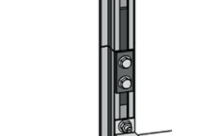
Zur Reduzierung von Spalten zwischen Steigschutzschiene.
