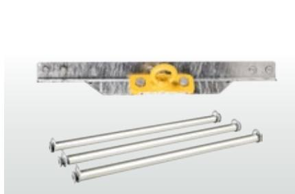
Gemäß EN 795 und ANSI Z359 (EN 795:2012 CEN/TS 16415 ANSI Z359.1, OSHA 1910.66, OSHA 1926.502). Durch spezielles Design passend für kleine und große Karabinerhaken. Stahl feuerverzinkt / beschichtet. Mittige Montage benötigt gegenüberliegende Steigschutzschiene.
